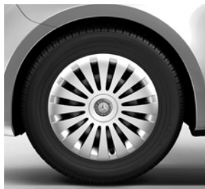
43,2 cm (17") Stahlrad (Serie für 140 kW) (RS7)
