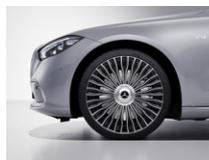
Bitte beachten Sie: Je geringer bei einer bestimmten Radgröße der Querschnitt der Reifen ist, desto schlechter ist der Fahrkomfort auf schlechten Straßen. Abroll- und Dämpfungskomfort nehmen ab und die Gefahr, dass es beim Überfahren von Hindernissen zu Beschädigung von Reifen und Rädern kommt, steigt.
