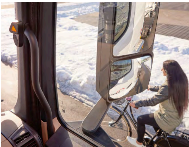
Besteht unmittelbare Kollisionsgefahr alarmiert der Assistent den Fahrer
