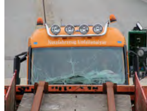
Prüfung auf Biegen und Brechen: Dachlampenbügel im Crashtest.
