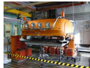
Hydropulsprüfstand zur Simulation von Schlaglöchern und schlechten Straßen.
