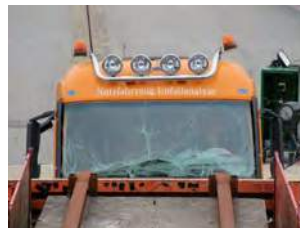
Prüfung auf Biegen und Brechen: Dachlampenbügel im Crashtest.
