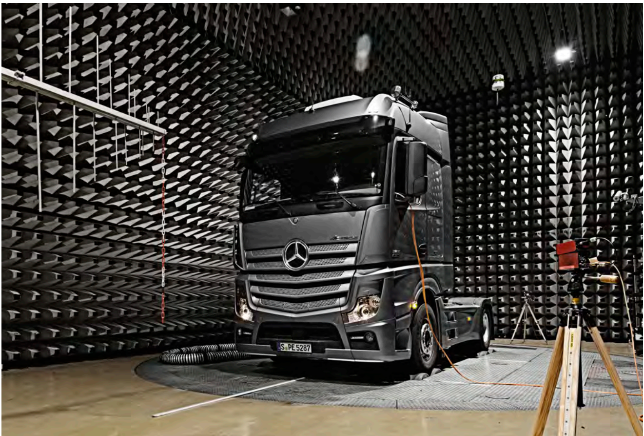
EMV-Prüfung in einer speziell vor elektromagnetischen Fremdstörungen abgeschirmten Halle.
