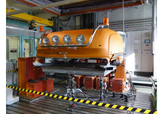
Hydropulsprüfstand zur Simulation von Schlaglöchern und schlechten Straßen.
